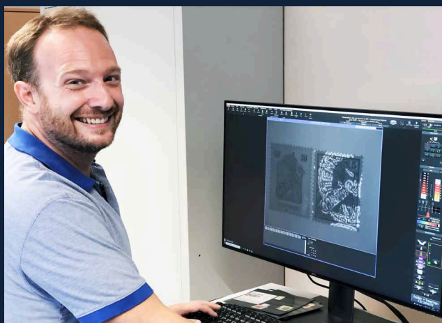
Tobias Huylmans präsentiert mittels Spektralanalyse des VSC 8000 einen echten China-Handstempel (rechts) und einen falschen (links).
